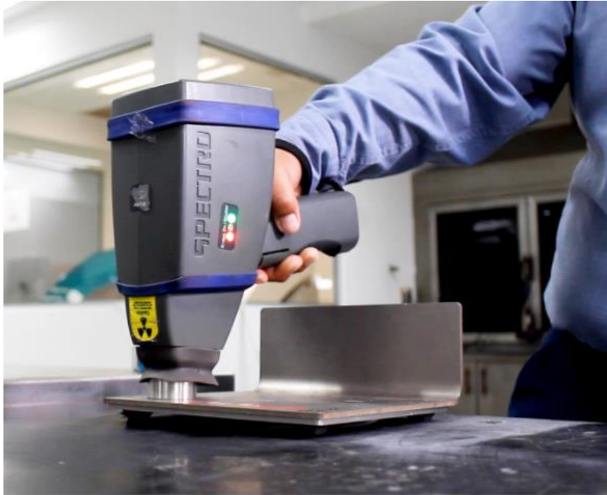
Fig. 47: Realización del análisis químico. Fuente: https://www.blog.metalinspec.com.mx
