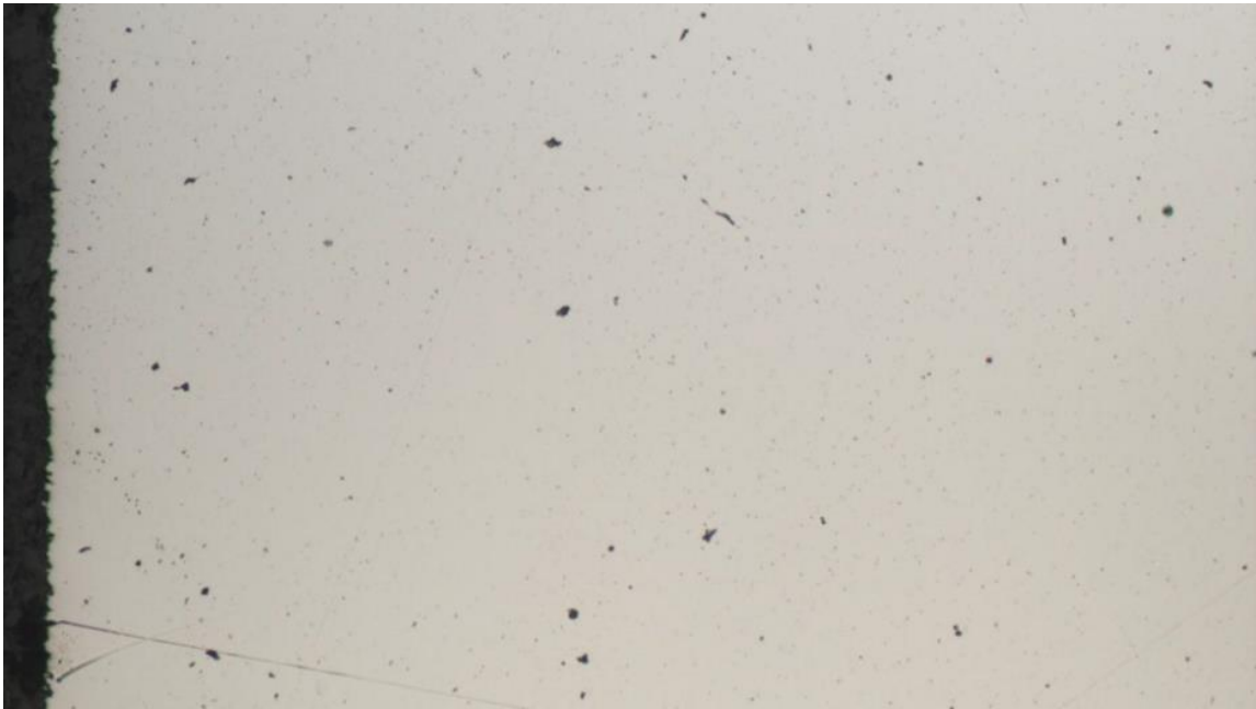
Fig. 41: Metalografía 100X. realizado en muestra NG. se observan poros y glóbulos de oxido (manchas circulares negras). Fuente: https://www.blog.metalinspec.com.mx
