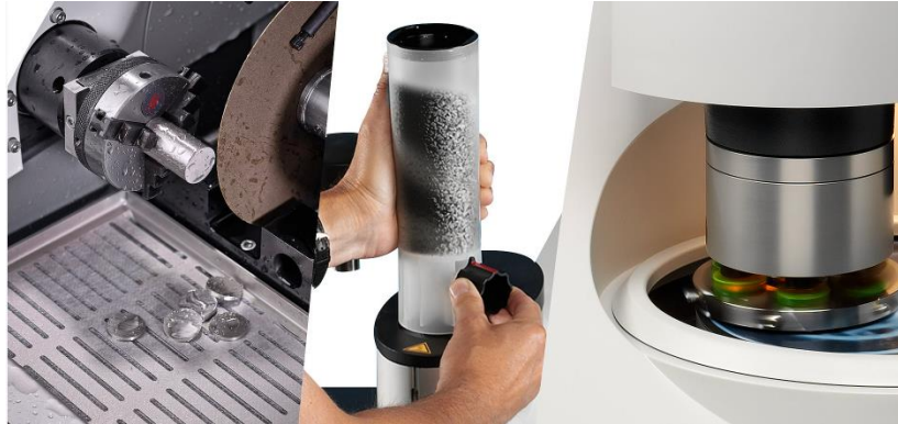
Fig. 25: Preparación de muestra metalográfica. Fuente: https://www.blog.metalinspec.com.mx
