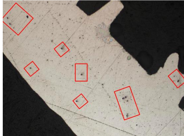
Fig. 37: Porosidad (dentro de los rectángulos rojos). Fuente: https://www.blog.metalinspec.com.mx
